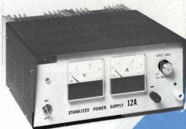
Alimentatore stabilizzato "G.B.C." Con strumenti di misura e protezione elettronica contro il cortocircuito. Tensione d'ingresso: 220 V - 50 Hz Tensione d'uscita regolabile: 6 ÷ 14 Vc.c. Corrente max d'uscita: 12 A NT/0530-00
