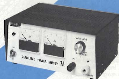
Alimentatore stabilizzato "GBC" Con strumenti di misura e protezione elettronica contro il cortocircuito Tensione d'ingresso: 220 V - 50 Hz Tensione d'uscita regolabile: 6 ÷ 14 Vc.c. Corrente max d'uscita: 8 A Dimensioni: 200x190x100 NT/0528-00
