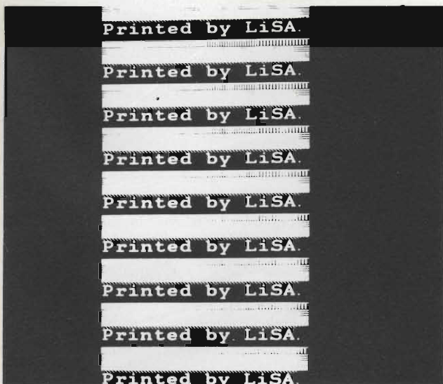
Fig. 8 - Immagini prodotte da una singola unità LiSA sperimentale capace di produrre 12 punti/mm.
