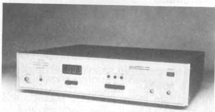
Analizzatore di distorsione mod. 6900 della Krohn-Hite in grado di coprire il campo di frequenza da 5 Hz ad 1 MHz con annullamento automatico della frequenza fondamentale.
