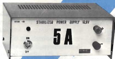
Alimentatore stabilizzato "GBC" Con protezione elettronica contro il cortocircuito Tensione d'ingresso: 220 V - 50 Hz Tensione d'uscita: 12,6 V Corrente d'uscita: 5 A Dimensioni: 180x140x78 NT/0085-00
